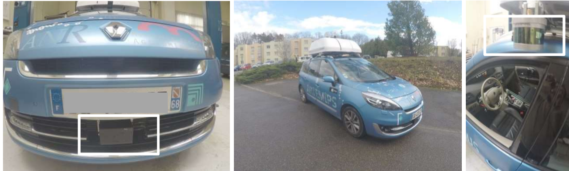
Figure 3 : Le véhicule ARTEMIPS de l'IRIMAS. Détail de quelques équipements pour la perception de la conduite autonome. A gauche, face avant du véhicule avec un télémètre laser à longue portée (150 mètres) au-dessous de la plaque d'immatriculation. Au milieu, une vision d'ensemble du véhicule. A droite, le poste de contrôle avec le volant instrumenté pour une conduite autonome et à l'extérieur dans la partie supérieure, un télémètre laser à courte portée (50 mètres).
