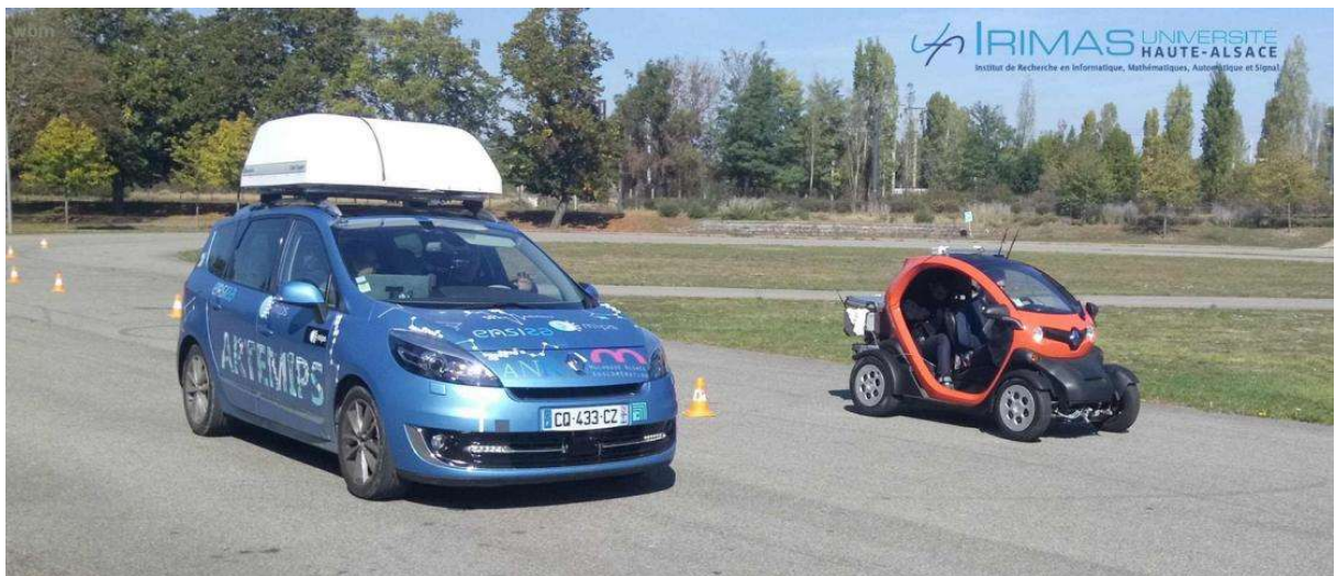
Figure 2 : Vue d'ensemble des deux prototypes de véhicule autonome de l'IRIMAS. Au premier plan « ARTEMIPS » et au second plan « POCLETTE ». ARTEMIPS est un véhicule autonome équipé pour prendre en charge à son bord une personne en situation d'handicap (travaux réalisés dans le cadre du projet SIMPHA). POCLETTE est un véhicule électrique léger de petit gabarit permettant de valider les concepts à l'aide d'une instrumentation bas coût et peu encombrante.
